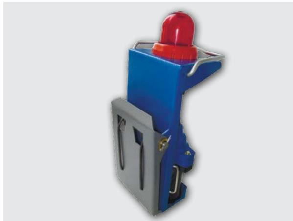
Светильник НГР исп.03 (мигающий на вагонетку, аналог СМР) предназначен для подачи мигающих световых сигналов, обозначающих последнюю вагонетку рудничного поезда с целью предотвращения наезда на впереди стоящий состав и визуального контроля машинистом сцепленности (целостности) состава.
